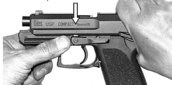
Arretramento del carrello fino al blocco di sgancio
