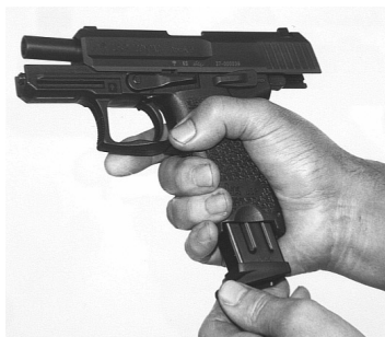
Operazione di sgancio del caricatore, usando il pollice della mano che spara
