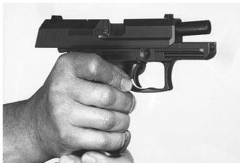
Operazione di sgancio del caricatore, usando l'indice della mano che spara
